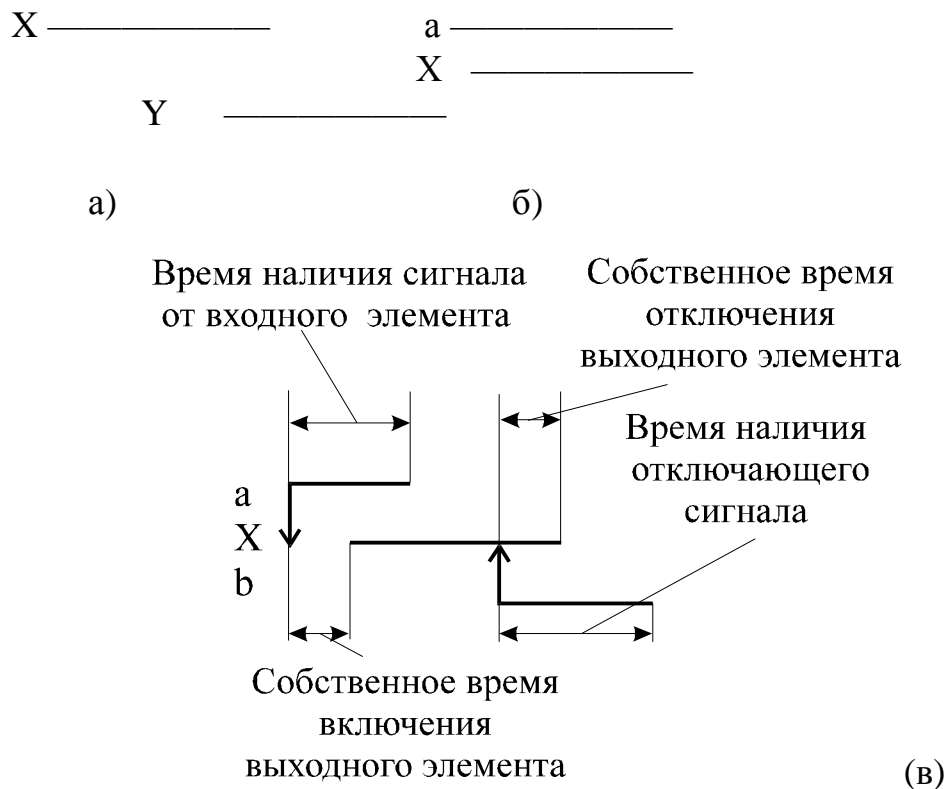
Рис. 1.10. Изображение сигналов и периодов работы элементов на циклограмме ( а - обозначение сигналов, б - обозначение последовательности работы, в-собственное время работы элемента)
