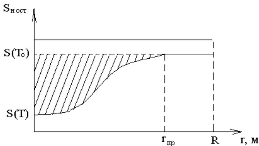
На графике заштрихованная область соответствует объему дополнительно добытой нефти.
